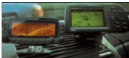
Bild 1: Zweckmäßige Kombination: Streetpilot von Garmin mit Kenwood TM-D700E
